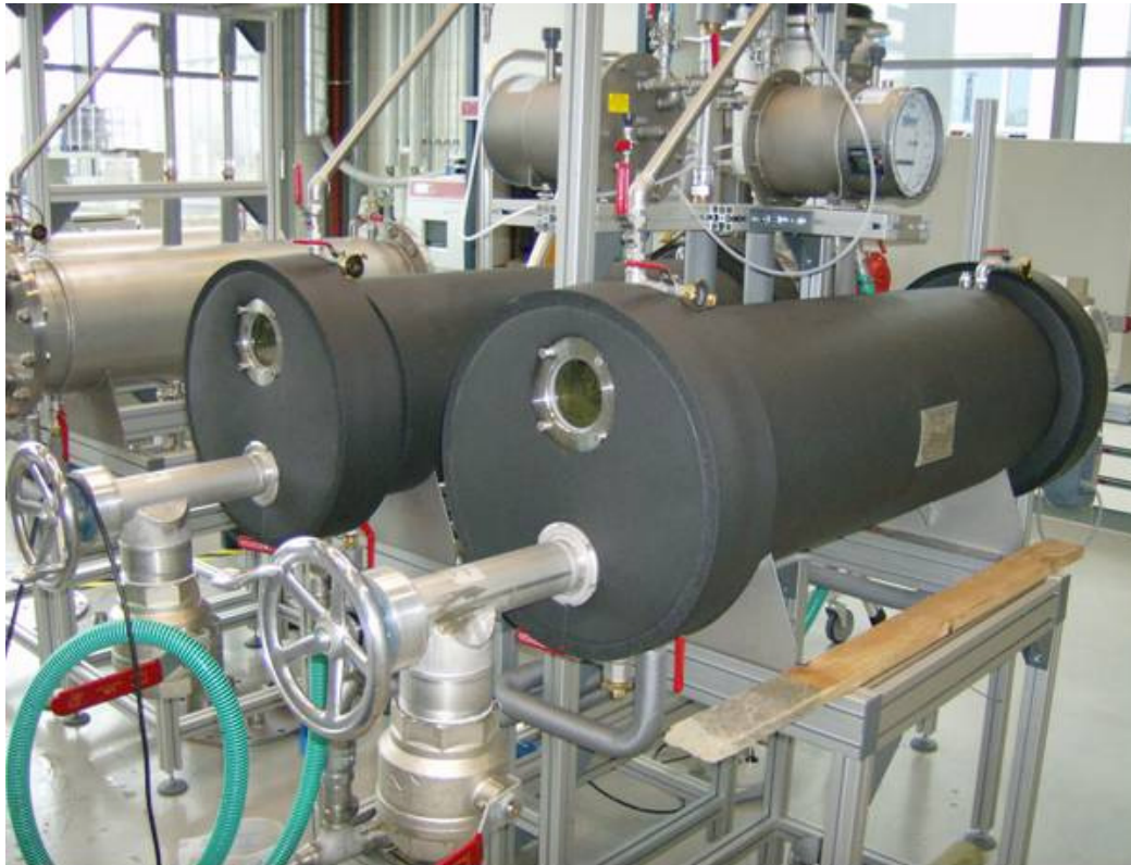
Abbildung 12: Durchfluss-Biogasfermenter im Halbtechnischen Maßstab (100 L).
